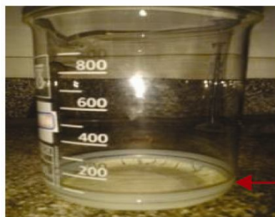
شکل ۴- رسوب به دست آمده از روش هموژنایزر.
