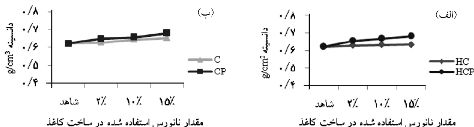
شکل ۹- تغییرات دانسیته کاغذ با افزودن نانورس با و بدون کمک نگهدارنده در (الف) نانورس خام و (ب) نانورس همگن‌شده.
