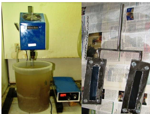
شکل ۲- دستگاه همزن و پره‌های مورد استفاده برای اندازه‌گیری مواد چسبناک میکرو.
