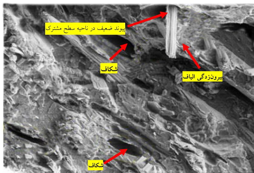
شکل ۵- تصویر میکروسکوپ الکترونی SEM چندسازه آرد چوب- پلی اتین سنگین بدون سازگارکننده (بزرگنمایی ۵۰۰).
