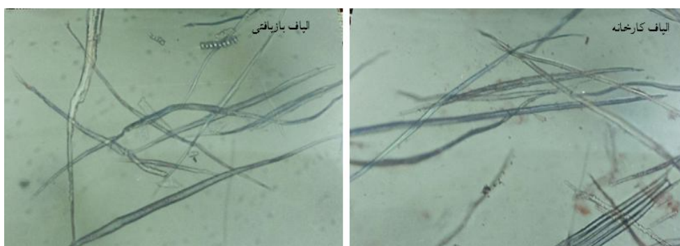
شکل ۴- تصاویر میکروسکوپی الیاف بازیافتی و الیاف کارخانه. Figure 4. Microscopic images factory fiber and recycled fiber.
