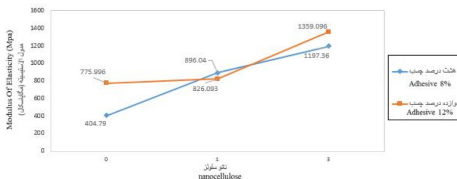
شکل ۶- اثر متقابل چسب و نانو سلولز بر روی مدول الاستیسیته.
