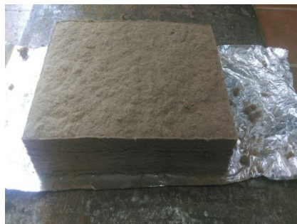
شکل ۲- تشکیل کیک الیاف.
