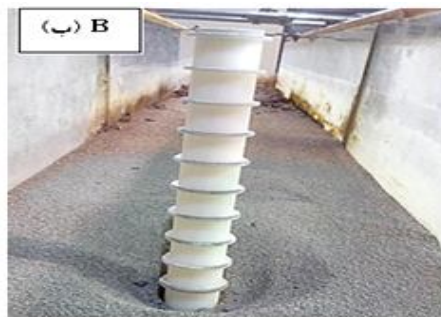
شکل ۲- طرح شماتیک، (الف) زبری های ایجاد شده اطراف پایه، (a) فاصله بین زبری ها، (b) بیرون زدگی زبری ها و (c) ارتفاع زبری ها، (ب) پایه مدل شده در آزمایشگاه.
