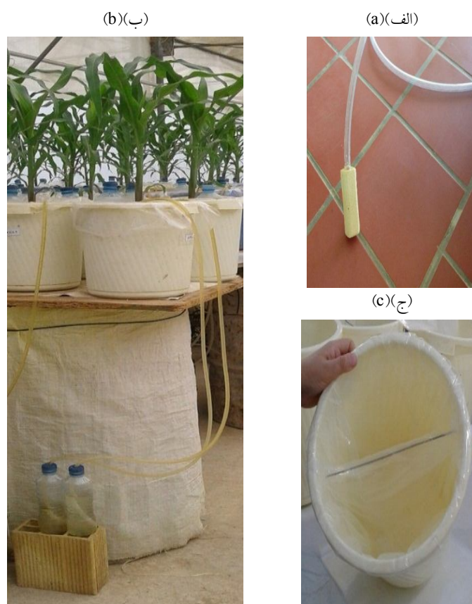
شکل ۱- نمایی از تانسومتر دست‌ساز (الف) کلاهک متخلخل (ب) چگونگی قرار گرفتن تانسومتر در گلدان (ج) محیط کشت با سازه جداکننده ریشه به دو بخش.
