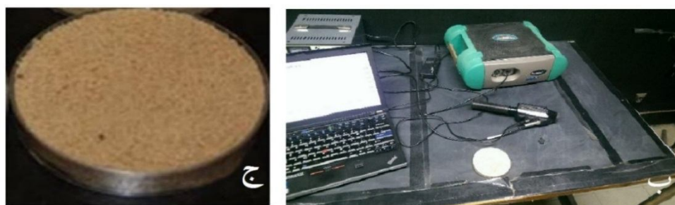
شکل ۱- موقعیت منطقه مورد مطالعه و نقاط نمونه برداری (الف)، تصویری از وسایل اندازه گیری انعکاس طیفی خاک در تاریکخانه، دستگاه FieldSpec@3 و لوازم جانبی آن (ب) و نمونه خاک آماده شده در پتری دیش (ج).
