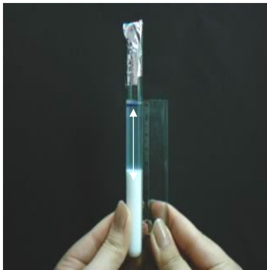
شکل ۱- نمایش روش اندازه‌گیری میزان جداسازی سرم در دوغ
