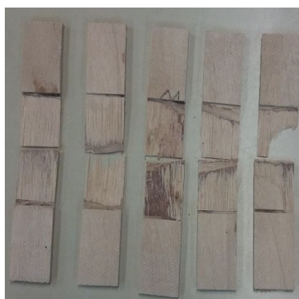
شکل ۲- نمونه‌های تخته‌لایه ساخته‌شده با چسب سویا بعد از انجام آزمون مقاومت برشی.
