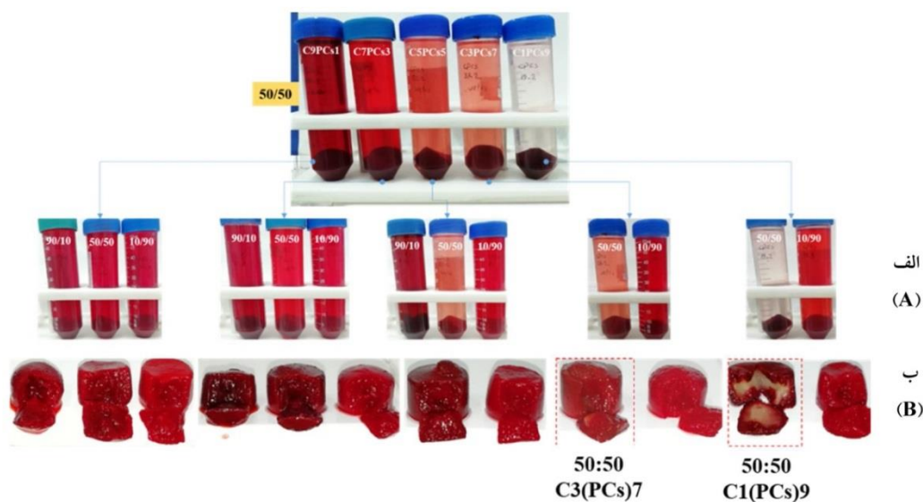
شکل ۱۲- جذب CR با غلظت (۴۰۰ میلی‌گرم بر لیتر) توسط آبروژل: پایداری آبروژل‌های سه‌جزئی و تفاوت جذب رنگ (الف)، ارزیابی نمای داخلی آبروژل سه‌جزئی CPCs پس از جذب CR (ب).
