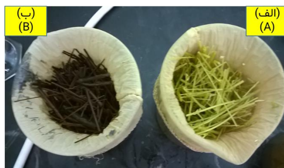
شکل ۳- خمیرهای حاصل از پخت SEW (الف) و سودا (ب) قبل از شستشو.
