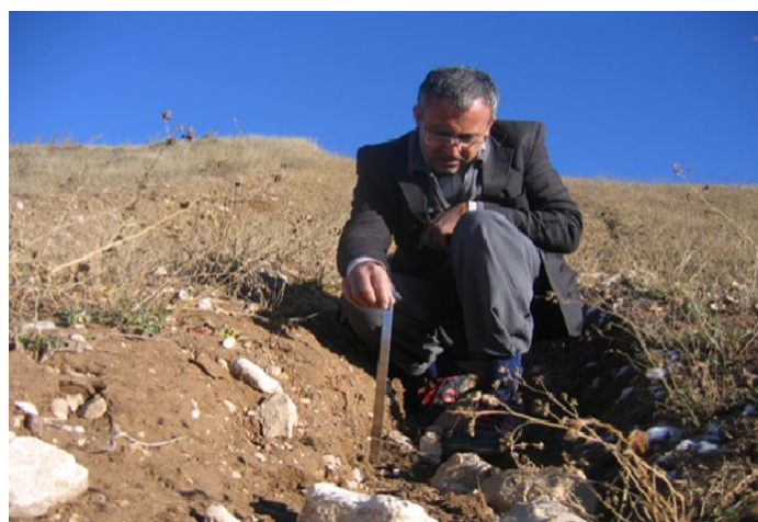
شکل ۳- نحوه اندازه‌گیری فرسایش در قطعه زمین دیم مورد بررسی با نوار با دقت سانتی‌متر.
