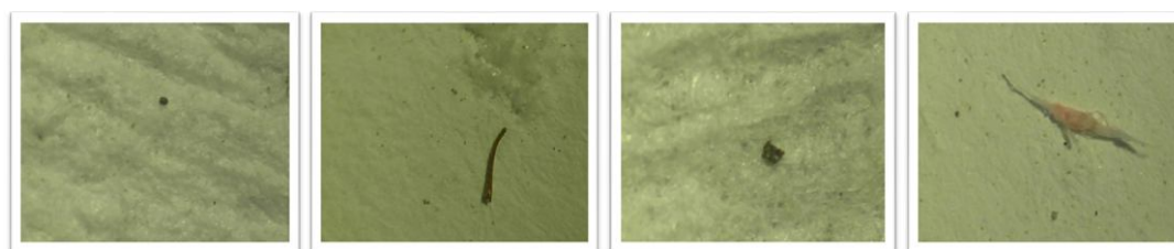
شکل ۳- ذرات میکروپلاستیک موجود در رسوبات منطقه هایپریک رودخانه زیارت با استفاده از استریومیکروسکوپ، به ترتیب از راست: فیبر، قطعه، رشته، گلوله.
