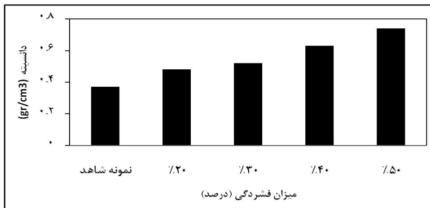
شکل ۳- دانسیته نمونه‌های فشرده شده صنوبر در مقایسه با نمونه شاهد.
