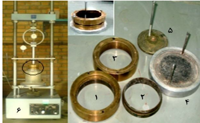
شکل ۱- قالب تراکم مورد استفاده برای تهیه نمونه‌ها به روش تراکم استاتیکی. ۱- رینگ تحتانی ۲- رینگ میانی ۳- رینگ فوقانی ۴- پایه آلومینیومی ۵- صفحه بارگذاری ۶- دستگاه تک محوری.
