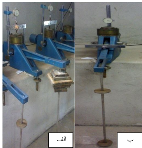
شکل ۲- دستگاه تحکیم مورد استفاده برای آزمایش تورم (الف) و فشار تورمی (ب). Figure 2. Used odometer cell for (A) Swelling and (B) Swelling pressure test.
