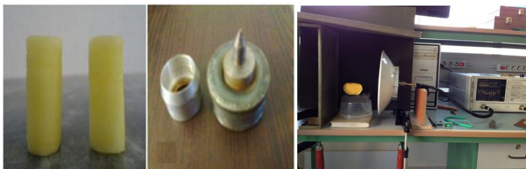
شکل ۱- سامانه انتقال فضای آزاد برای اندازه گیری ثابت دی الکتریک به روش غیر مخرب (راست).
