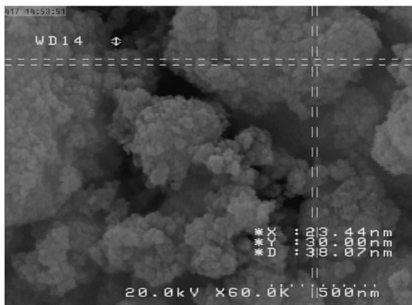
شکل ۲- تصاویر SEM برای نانوکامپوزیت (\text{Ni}_{0.5}\text{Zn}_{0.5}\text{Fe}_2\text{O}_4) (۲). Figure 2. SEM Images for Nanocomposite (\text{Ni}_{0.5}\text{Zn}_{0.5}\text{Fe}_2\text{O}_4) (2).
