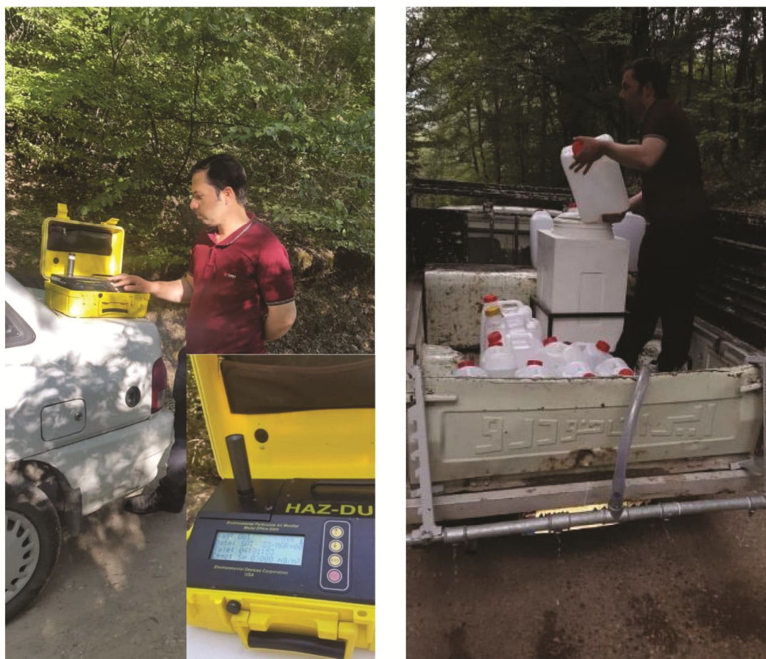
شکل ۳- (الف) سامانه اسپری محلول‌های ضدغبار، (ب) دستگاه غبارسنج مدل HAZ-DUST EPAM-5000.
