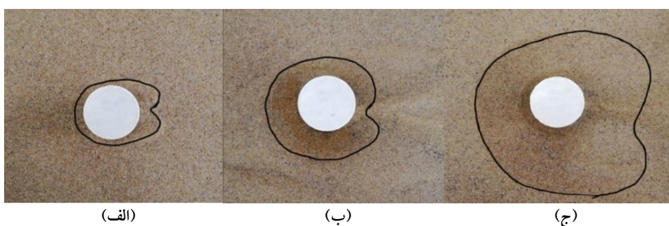
شکل ۱۴- توسعه حفره آبشستگی در حالت با برداشت حفره با H/D=0/8 برای عدد فرود (الف) 0/26 (ب) 0/38 و (ج) 0/43 . Figure 14. Development of scour holes around the bridge pier with mining holes at H/D=0.8 (a) Fr=0.26 (b) Fr=0.38 (c) Fr=0.43 .
