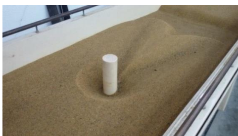
شکل ۱۶- گسترش تلماسه در پایین دست پایه پل.
