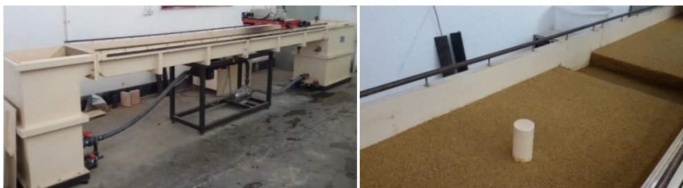
شکل ۱- (الف) فلوم آزمایشگاهی (ب) مدل آزمایشگاهی.
