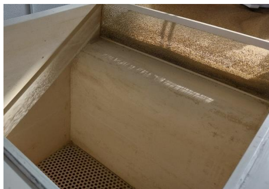
شکل ۲- آرام‌کننده جریان و صفحه مشبک مخزن بالادست.
