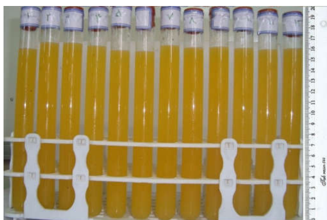
شکل ۵- فرمولاسیون‌های تهیه شده بر اساس جدول (۱) پس از نگهداری به مدت ۳ ماه در دمای ۴ درجه سانتی گراد Figure 5- Formulations prepared according to table 1 after 3 months storage at 4 °C
